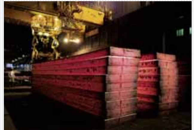
Im Brammenlager erhalten die Brammen eine Signatur: Über den Zeichen- und Zifferncode kann die Bramme später jederzeit rückverfolgt werden.
