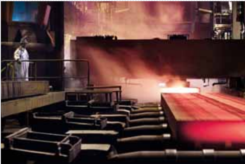
Ein paar Meter weiter schneidet die Brennschneidmaschine den Endlosstrang in Brammen.
