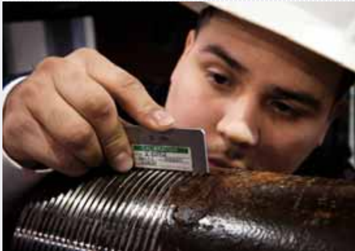
Bei Mercury Threading, einem Nachbearbeitungs- betrieb des Houstoner Standortes, werden Gewinde geschnitten. Heute hat José Juárez Nachtschicht – er überprüft gerade das Gewinde an einem Rohr für die Erdölbohrung.
